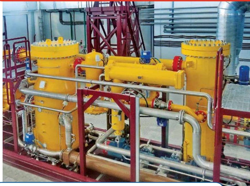
Фото 2. Многоступенчатая система сепарации газа, усиленная фильтром-скруббером
