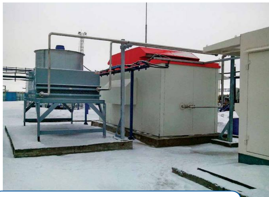
Фото 3. Рефрижераторный осушитель ПНГ на Западно-Могутлорском месторождении (РуссНефть)
