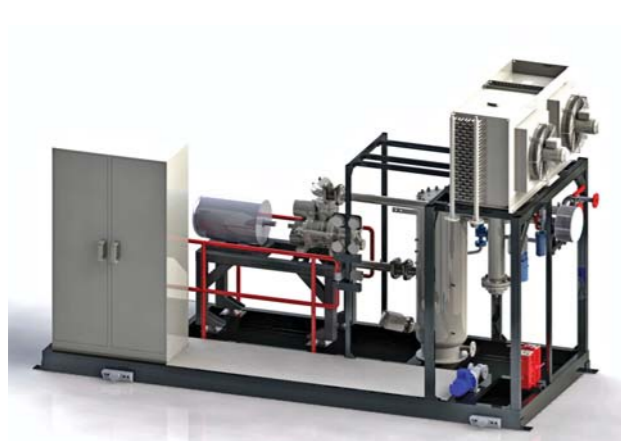
Рис. 1. 3D-модель малой газокompрессорной установки на открытой раме
