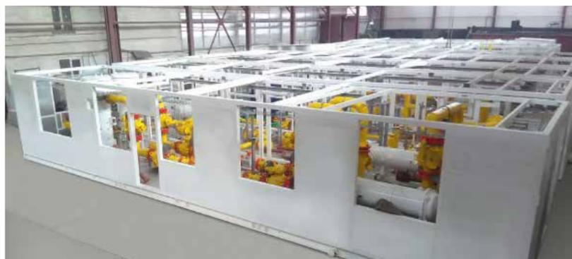
Фото 13. Многомодульная установка подготовки топливного газа на этапе цеховой сборки
